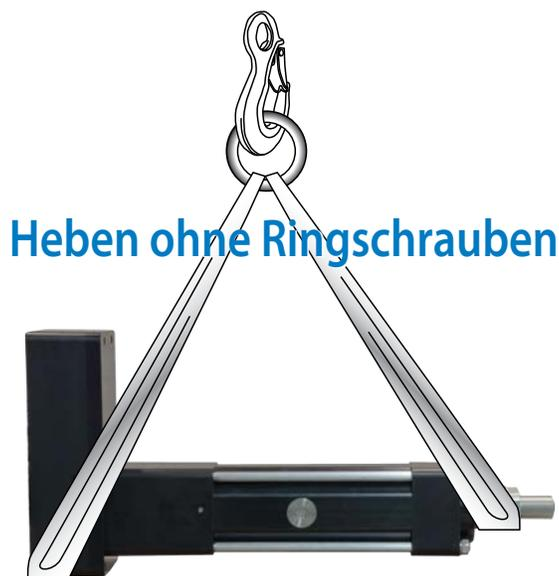
Abbildung 4-2 RSX richtig heben ohne Ringschrauben
